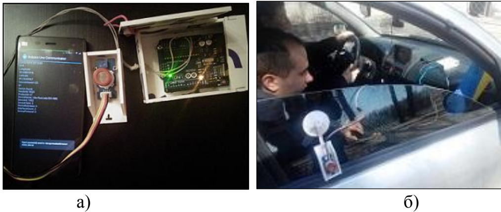
Рисунок 4 – ІВС, створена за запропонованою методикою для оцінювання параметрів моделі забруднення атмосферного повітря автотранспортом: а) програмно-технічне забезпечення ІВС; б) змонтована на автомобілі ІВС
