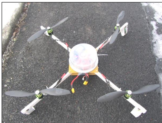
Рисунок 3.2 — Створений квадрокоптер під час проведення досліджень, та випробування його підйомної спроможності
