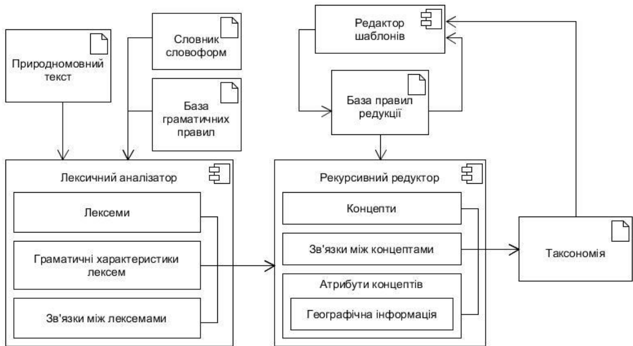
Рис. 3.9. Базова архітектура підсистеми структуризації текстів
