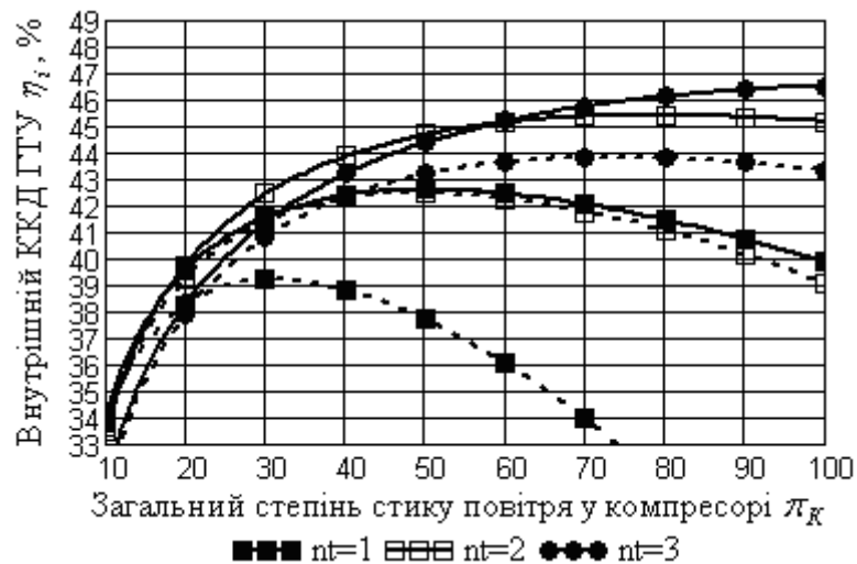
Рис. 4.8. Результати досліджень впливу збільшення кількості ступенів розширення газу n_t з проміжним підведенням теплоти та загального ступеня стиснення повітря \pi_K на внутрішній ККД циклу безрегенеративної ГТУ: штрихові лінії відповідають температурі газу на вході у газові турбіни t_{3Г} = 1200^\circ\text{C} ; суцільні лінії відповідають температурі газу на вході у газові турбіни t_{3Г} = 1500^\circ\text{C} ; ступінь розширення газу у проміжних газових турбінах становить 2,0; стиснення повітря одноступеневе [232]
