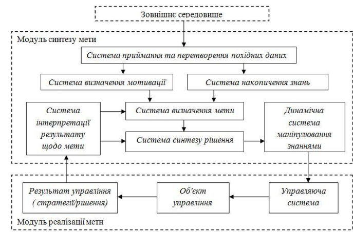
Рис. 1. Структурна схема системи інтелектуального управління вузла мережі
