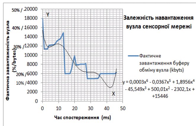
Рис. 4.4 Залежність завантаженості обчислювальної системи вузла СМ від часу процесу ПД
