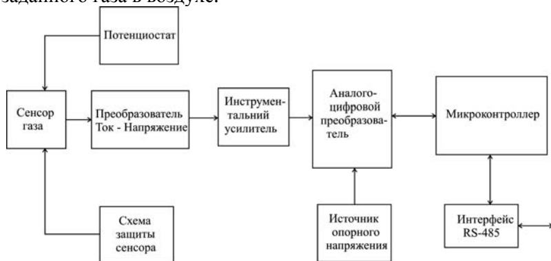
Рисунок 1. Структурная схема интеллектуального датчика.
