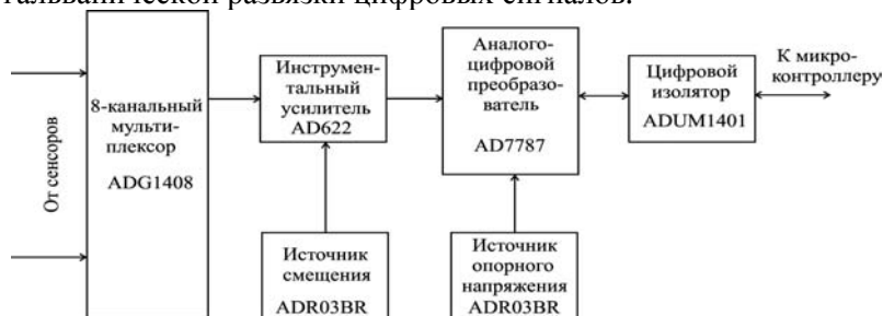
Рисунок 1. Структурная схема измерительного канала.
