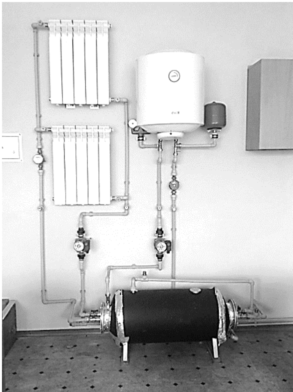
а) б) Рис. 8. Натурна модель (б) і схема дослідно-експериментального стенду (а) теплообмінника змієвикового типу з акумулюючою ємністю,
