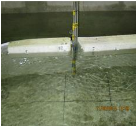
Рис. 6 – Измерение поля давления на полотне завесы модели струенаправляющего сооружения
