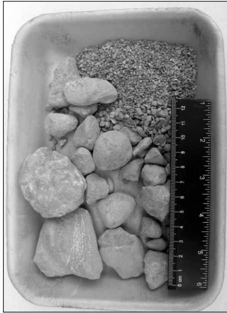
Рис. 2.2. Результати ситового аналізу донного осаду р. Дніпро в районі с. Корсунка: а - усереднений гранулометричний склад; б - галька, гравій та пісок з алювію у лівобережній заплаві.
