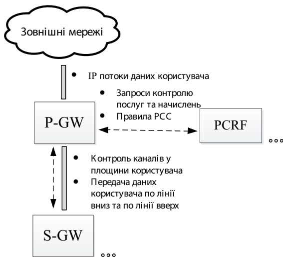
Рис. 5.32. Функції шлюзу P-GW
