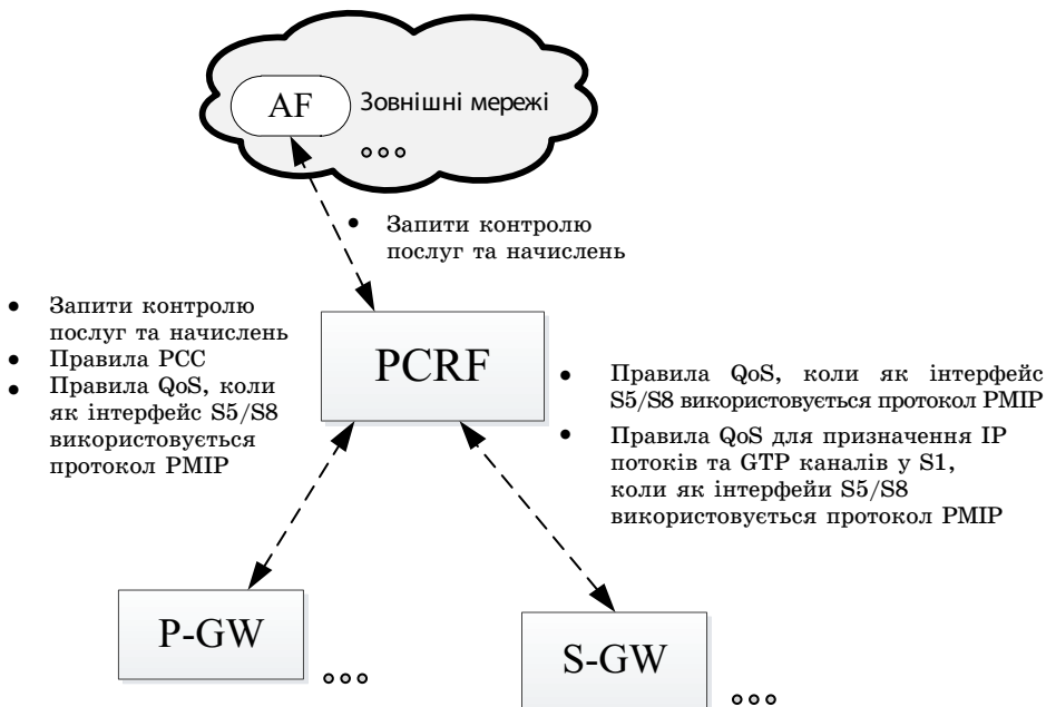
Рис. 5.33. Функції контролера PCRF
