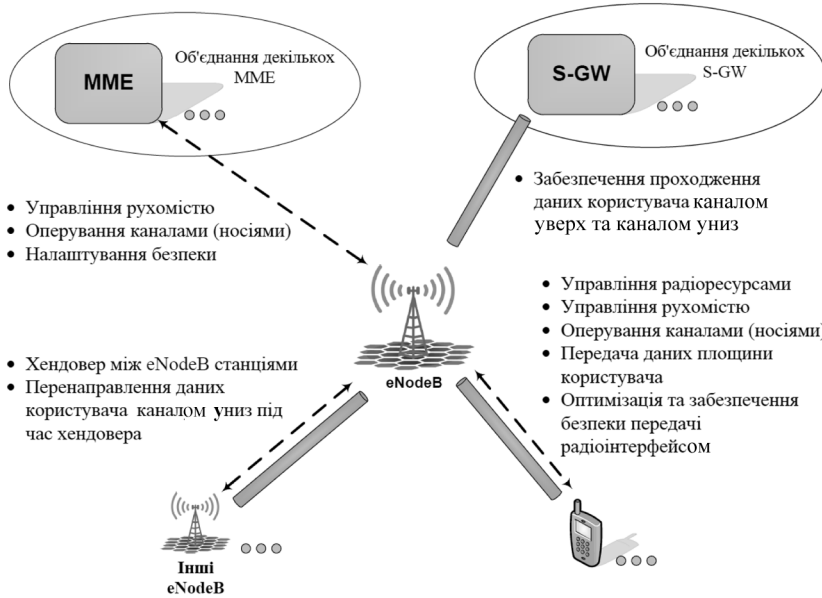
Рис. 5.29. Функції базової станції eNodeB
