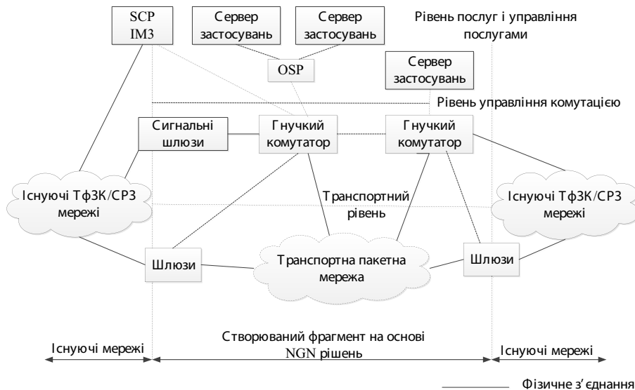
Рис. 1.3. Одновимірна тривірнева модель NGN [1.13]
