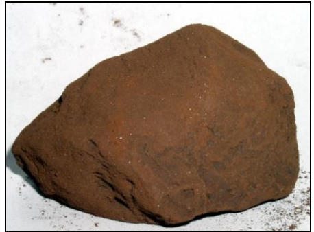
Рис. 8. Маггеміт у відходах металургійного виробництва: а – первинний у вигляді ідіоморфних скелетних білих у відбитому світлі кристалів в кулястому зерні з металургійним скло. Акумуляюча емність. Полірований шліф, збільшення 150\times ; б – у складі перевідкладеного гіпергенно зміненого тонкозернистого магнітного (!) шламу цегельно-бурого кольору, з лімонітом. Без збільшення.
