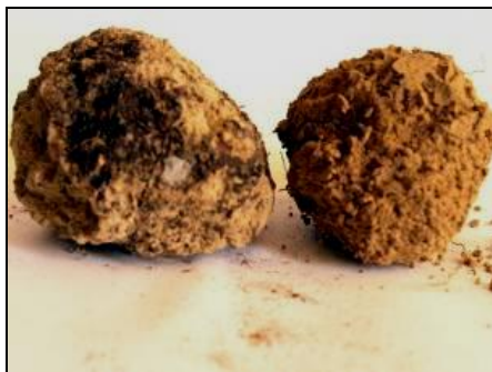
Рис. 4. Кулясті мінеральні агрегати у відходах металургійного виробництва: а - кулясте зерно шламу, сформоване металургійним склом і скелетними кристалами магнетиту. Полірований шліф, збільшення 70^{\times} ; б - округлі глиняні котуни, що потрапили до шламу внаслідок розмиву дамби шламосховища. Без збільшення.
