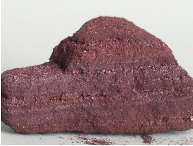
Рис. 7. Забарвлений дисперсним гематитом верстуватий шлам мартенівського цеху. Біле – кварц, карбонати і металургійне скло. Без збільшення.
