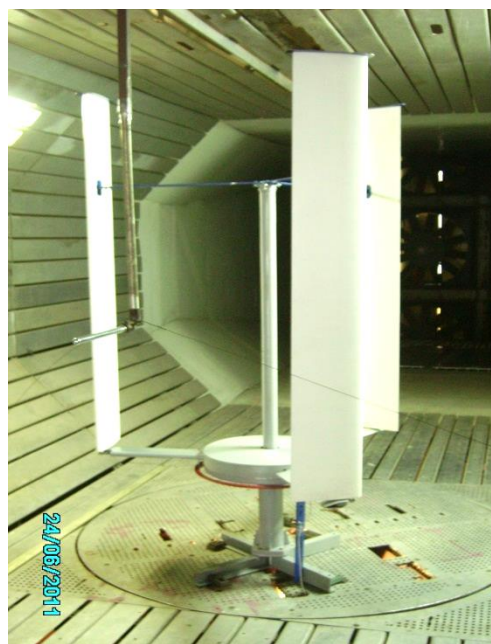
Рис. 5 – Ветроротор-3 (2012 г.) с механизмом управления № 2 в аэродинамической трубе НАУ
