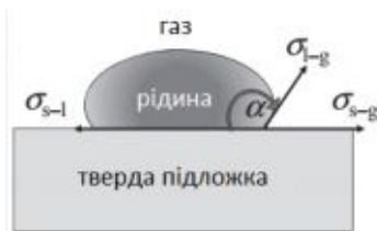
Рис. 7 Рівновага поверхневих напружень при контакті тверда поверхня-рідина.
