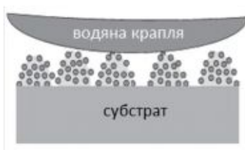
Рис. 8 Контактна ситуація у випадку ефекту Лотоса. Через гофровану лверхню створюється ситуація величезного кута контакту \alpha .
