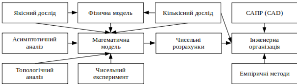
Рисунок 1 – Схема аналітичної підготовки проведення обчислювального експерименту у гідродинаміці
