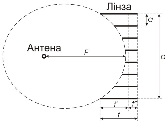
Рис. 2.12. Схематичне взаєморозташування антени і ПЛ (вид зверху), де F – фокусна відстань, t = t' + t'' – максимальна довжина профілю, d – ширина, a – відстань між окремими профілями
