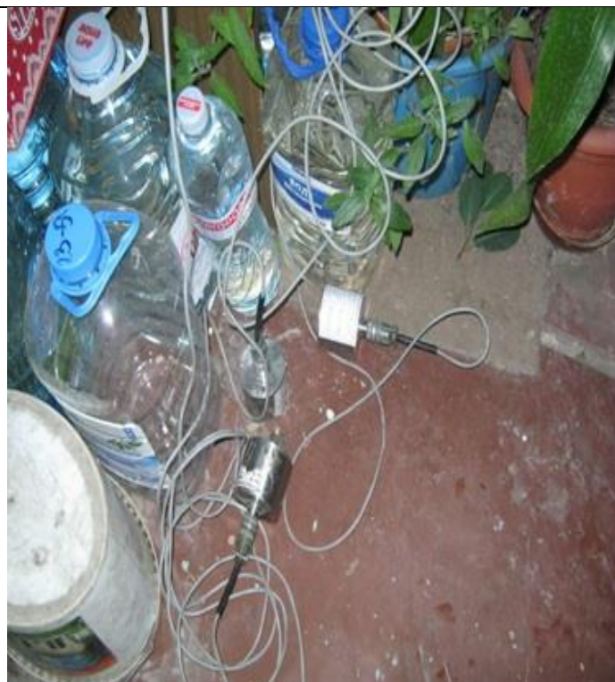
Рис. 4.4 – Вібродатчики № 4 та № 5 для реєстрації коливань будинку в рівні верхнього 9-го поверху відповідно за напрямками X, Z або Y, Z
