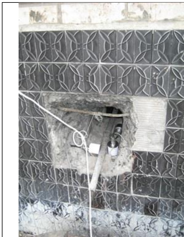
Рис. 4.3 – Вібродатчики № 1–№ 3 для реєстрації коливань будинку в рівні фундаменту за напрямками X, Z та Y
