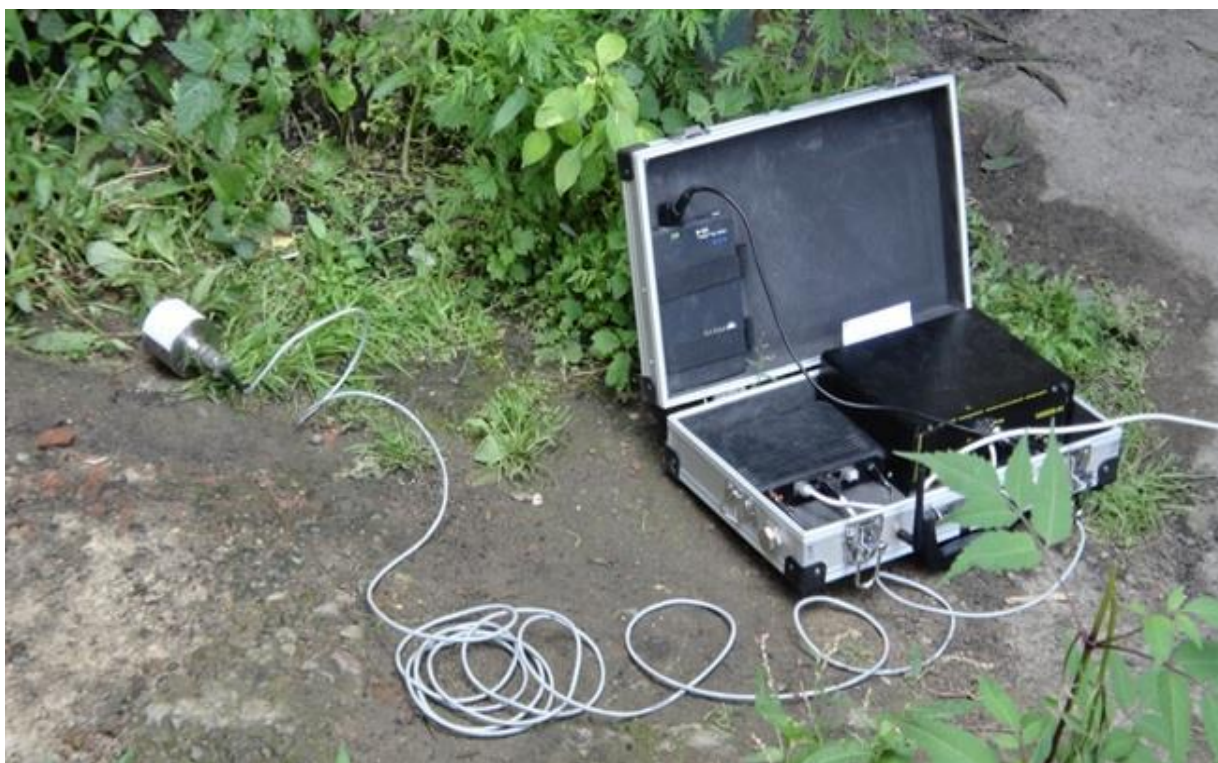
Рис. 1.17. – Загальний вигляд реєструючої віброметричної апаратури, що складається з прецизійного датчика, підсилювача та провідного (безпроводного) передатчика сигналу
