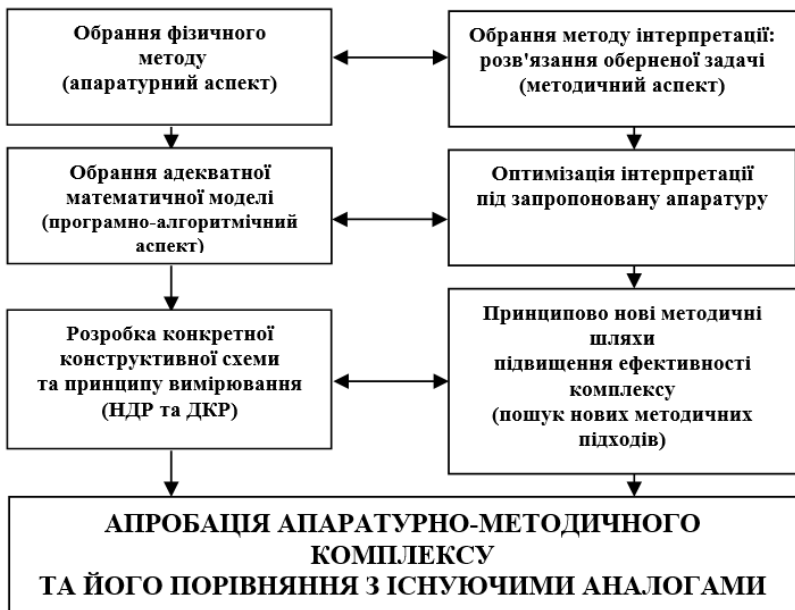
Рис. 1. Структурно-методологічна схема розробки програмно-методичного забезпечення для виконання науково-дослідних та дослідно-конструкторських робіт геофізичного приладобудування
