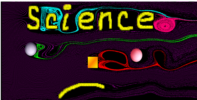
Рис. 1. Візуалізація обтікання довільних тіл за допомогою системи частинок
