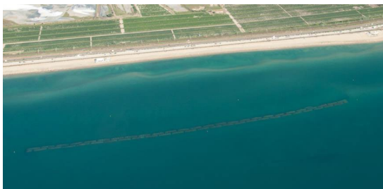
Рис. 1. Підводний хвилелом на Атлантичному узбережжі Франції
