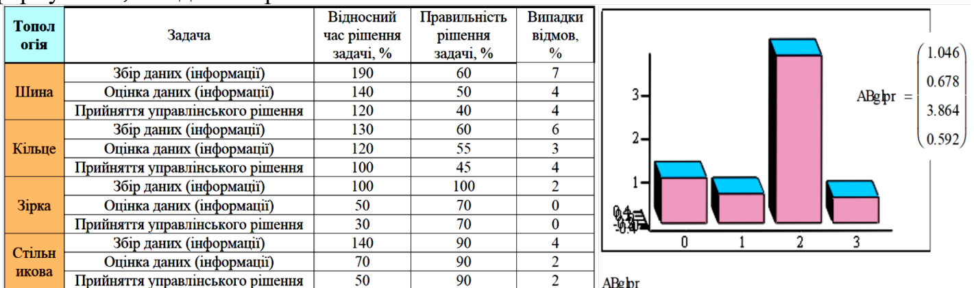
Рис.5. Результати експериментальних досліджень з вивчення процесів функціонування можливих варіантів топологій МІ
