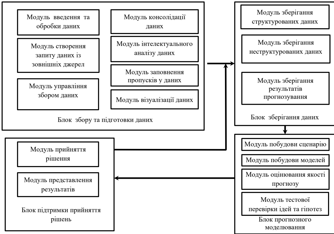
Рисунок 10 – Спрощена концептуальна схема СППР
