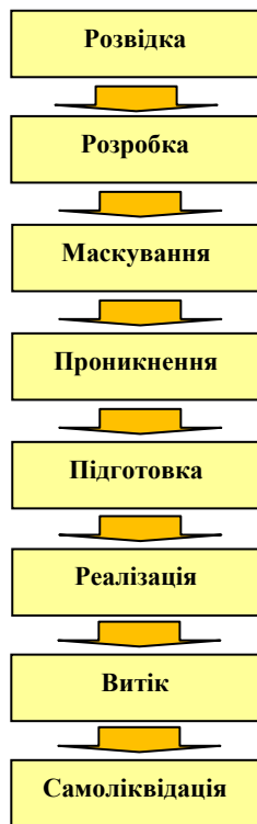
Рис.3.6. Модель атаки в АСУ ОКІ за допомогою ПЗ реалізації атак
