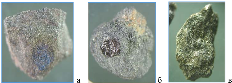
Рис. 2.18. Сульфіди, принесені до Інгульця у складі продуктів видобутку і збагачення залізистих кварцитів: а – кірка піротину на магнетитовому кварциті; б – пірит на зерні біотитового сланцю з магнетитом; в – хлорит-біотитовий сланець з піритом. Бінокуляр. Збільшення: а, б - 30^{\times} ; в - 25^{\times} .
