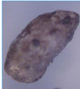
Рис. 3.3. Компоненти відпрацьованої формувальної суміші під мікроскопом: зростки металевого заліза з ільменітом (а); зростки магнетиту з кварцом (б); кірка глинистих мінералів, гідроксидів заліза і кварцу на поверхні кулястого корольку заліза (в); магнетит і гідроксиди заліза (г); кірки магнетиту, гідроксидів заліза і глинистих мінералів на кварці (д); пригарок (е). Бінокулярний мікроскоп. Збільшення - 100 x .
