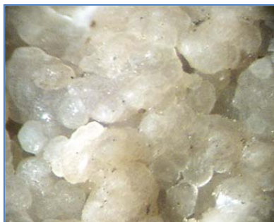
Рис. 2.5. Форми виділення карбонатів у складі травертину: а – сфероїдальні натічні агрегати; б – кірки, щітки і плівки. Бінокуляр, збільшення: а- 300^{\times} ; б - 200^{\times} .
