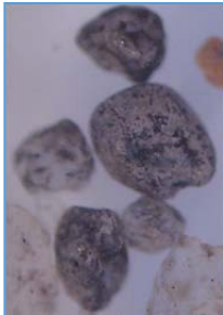
Рис. 3.3. Компоненти відпрацьованої формувальної суміші під мікроскопом: зростки металевого заліза з ільменітом (а); зростки магнетиту з кварцом (б); кірка глинистих мінералів, гідроксидів заліза і кварцу на поверхні кулястого корольку заліза (в); магнетит і гідроксиди заліза (г); кірки магнетиту, гідроксидів заліза і глинистих мінералів на кварці (д); пригарок (е). Бінокулярний мікроскоп. Збільшення - 100 x .
