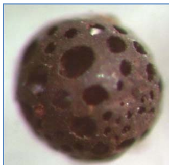
Рис. 2.26. Пористі зерна золота з проявами скелетного та дендритного росту (а), деформовані порожнисті кулі заліза (б, в) та його оксидів з пилу і шламів металургійних комбінатів. А – РЕМ, МЗА; б-г – бінокуляр; д – полірований шліф. А – алювій р. Дніпро в районі с. Корсунка; б-г – донний осад акумулюючої ємності ПАО АМКР; д – алювій р. Громоклій. Збільшення: б, в – 100\times ; г – 150\times ; д – 110\times .
