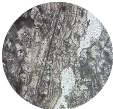
Рис. 2.4. Травертин під мікроскопом: а – мікрошаруватий; б – концентрично-зональний з великою кількістю. пустот. Прозорий шліф, ніколі паралельні, збільшення 25^{\times} .
