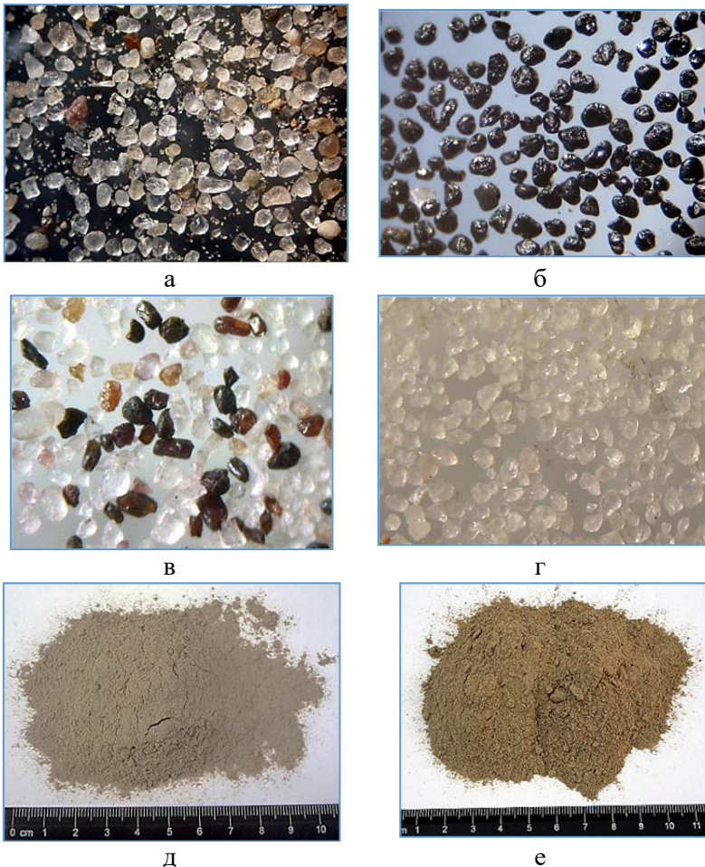
Рис. 3.5. Вихідні піски (а) і продукти їх переробки у вихровому повітряно-мінеральному потоці: ільменітовий концентрат (б), комплексний рутил-цирконовий концентрат (в), кварцовий пісок (г), маршаліт (д) і глина (е). А – г – бінокуляр, збільшення 60^{\times} .
