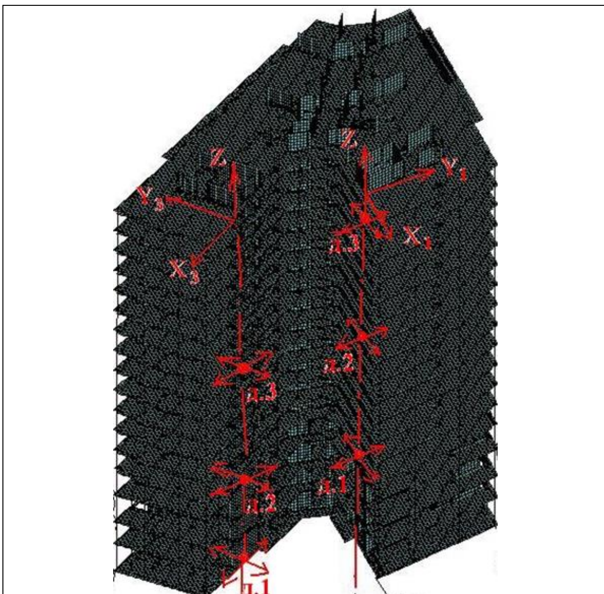
Рис. 2.1. Просторова скінченно-елементна модель будівлі з датчиками вібрації (Д.1, Д.2 та Д.3) системи вібромоніторингу (а) та плоска динамічна модель з розподіленими параметрами при поступових Y_0(t) сейсмічних впливах
