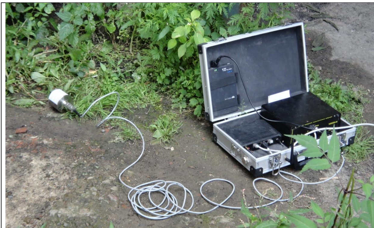
Рис. 2.4. Загальний вигляд реєструючої віброметричної апаратури для динамічних обстежень (Фото Калюха Ю.І.)
