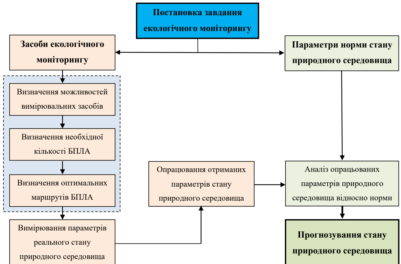
Рисунок 2.5. Розвинута методика проведення екологічного моніторингу сміттєзвалищ з використанням БПЛА
