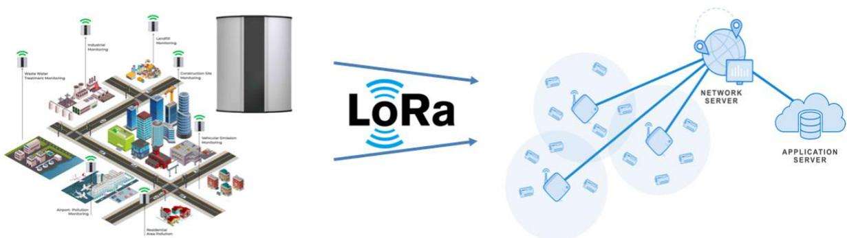
Рисунок 1.5 – Підхід до збору і обробки даних на основі LoRa
