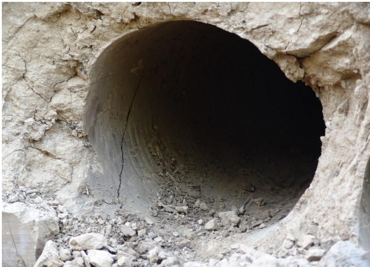
Рис. 2.26. Характер деформування контуру свердловини після її буріння.
