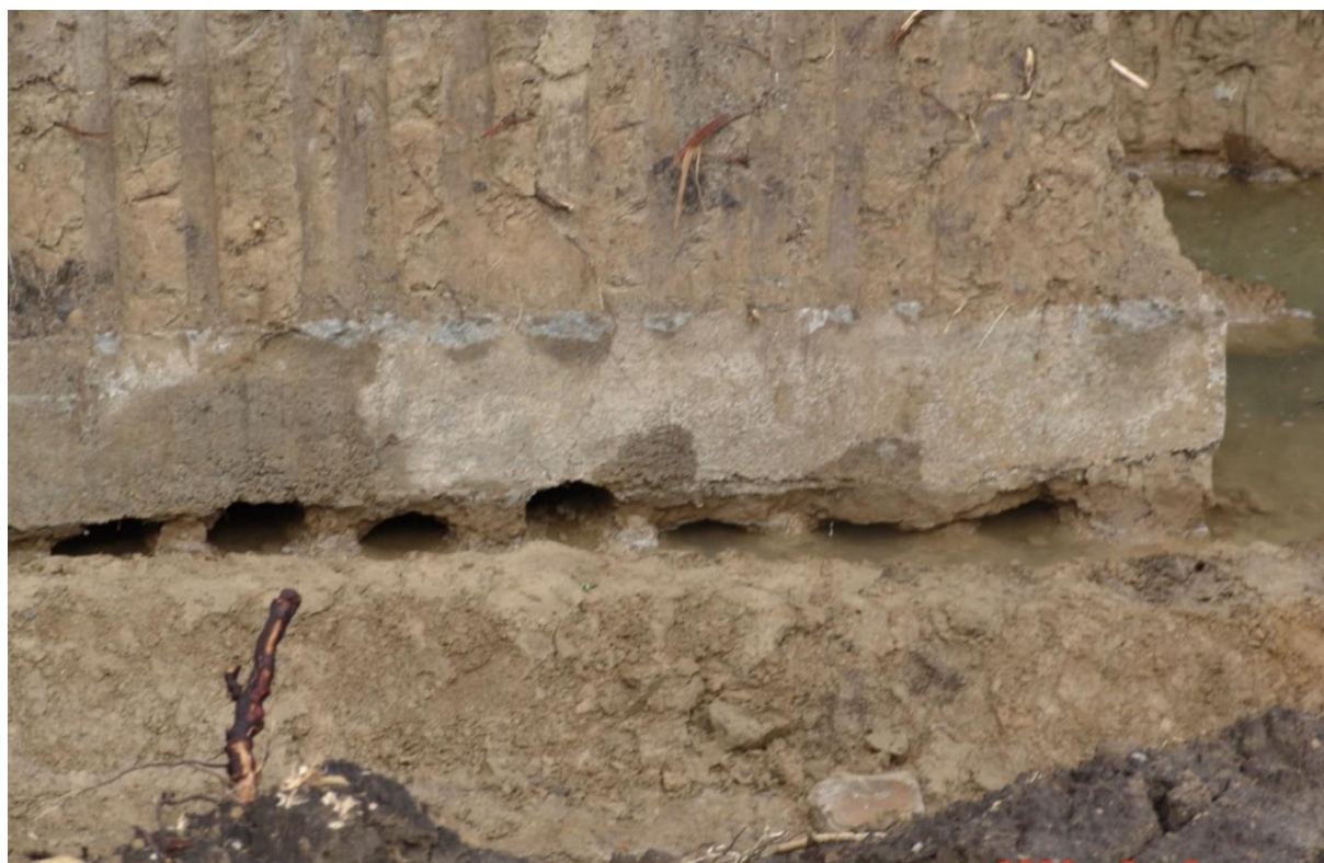
Рис. 2.26. Характер деформування контуру свердловини після її буріння.
