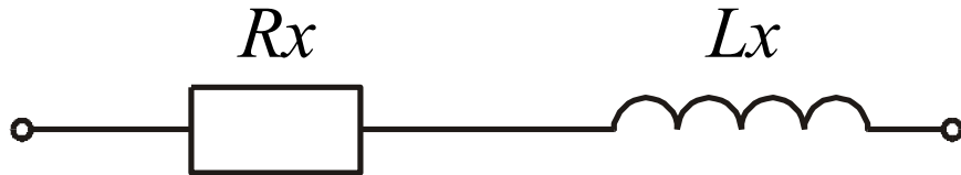
Рис. 2.6. Еквівалентна схема заміщення котушки індуктивності.
