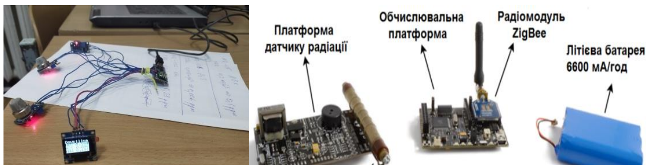
Рисунок 4.10. Зображення комплектації інтелектуальних сенсорних пристроїв сенсорного поля моніторингу стану радіаційної обстановки
