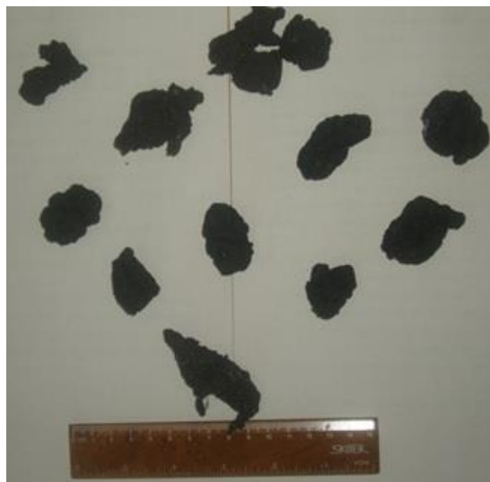
Рис. 3. Брикети з коксового пилу з добавкою пластику, отримані методом холодного брикетування (фото)
