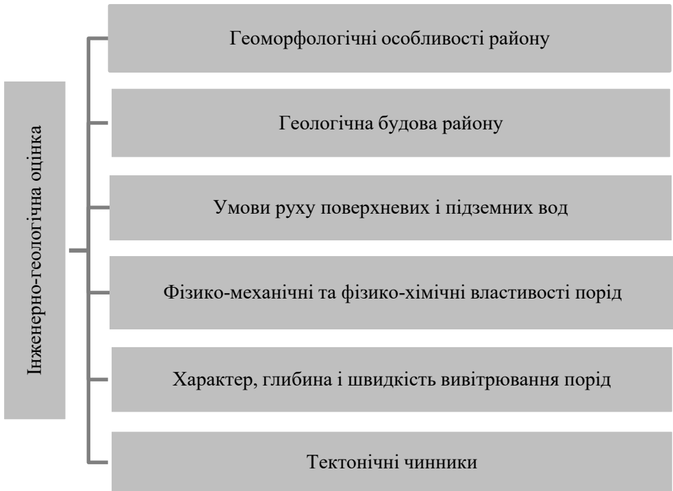
Рис. 4. Інженерно-геологічна оцінка можливості виникнення й розвитку суфозійних явищ і утворення пустот в ґрунтових греблях
