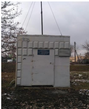
Рис. 3. Пост спостереження за забрудненнями атмосферного повітря в м. Харків на перехресті вулиць для контролю впливу автотранспорту
