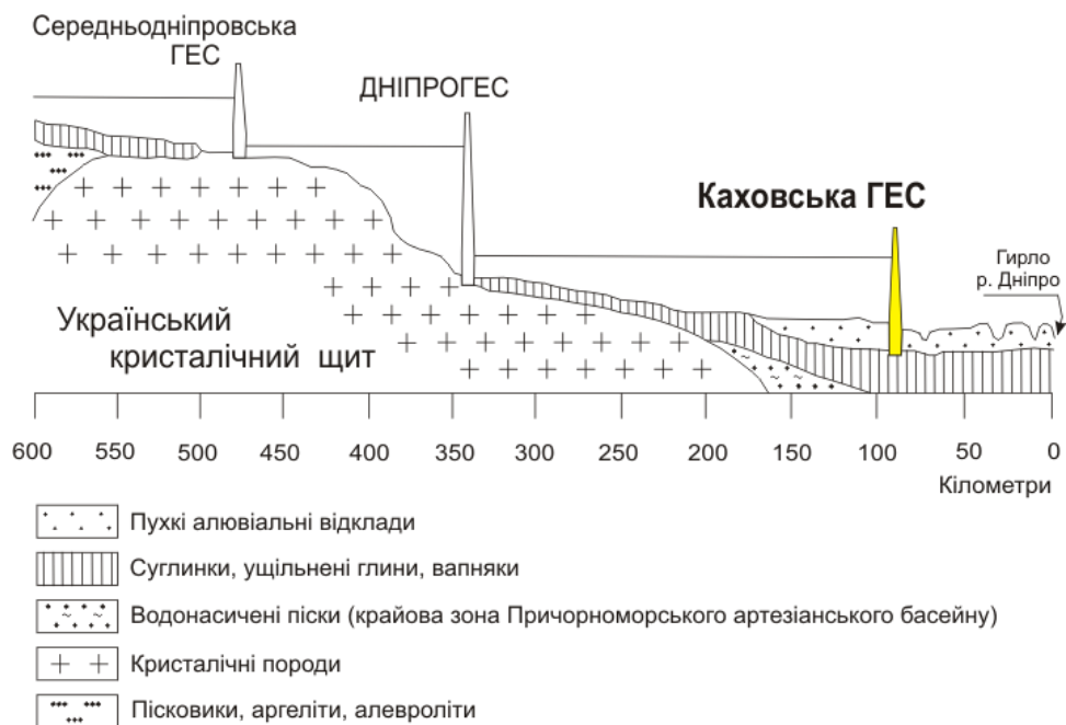
Рис. 4. Схема інженерно-геологічних умов в зоні впливу Каховського гідровузла, що провокують активізацію небезпечних процесів: підтоплення, просідань, зсувоутворення, карстово-провальних форм
