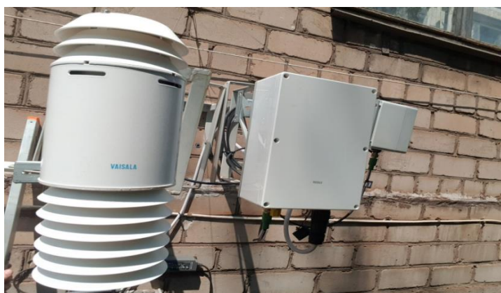
Рис. 4. Індикативний пост спостереження типу ENVEA
