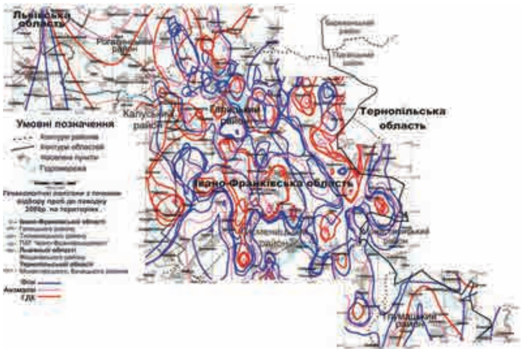
Рис. 4.36. Накладання ізоліній фону, аномалій та ГДК у ґрунтах станом на 2008 р. Автор Д.О. Зорін
