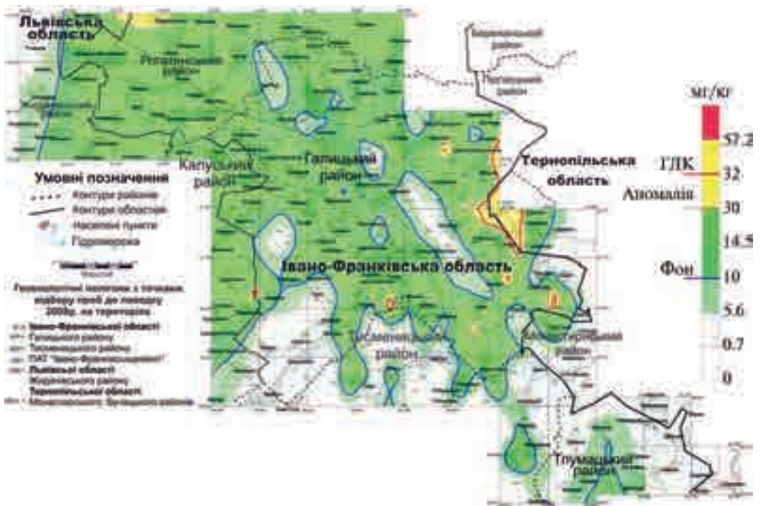
Рис. 4.32. Вміст Pb у ґрунтах станом на 2008 р. Автор Д.О. Зорін
