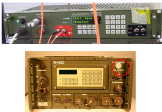
Рис. 1.3 Апаратура IP шифрування (IP SEK) з флеш-накопичувачем вводу ключа та радіорелейна станція R-450 з флеш-накопичувачем вводу ключа типу AES 128, AES 256 з національними алгоритмами шифрування
