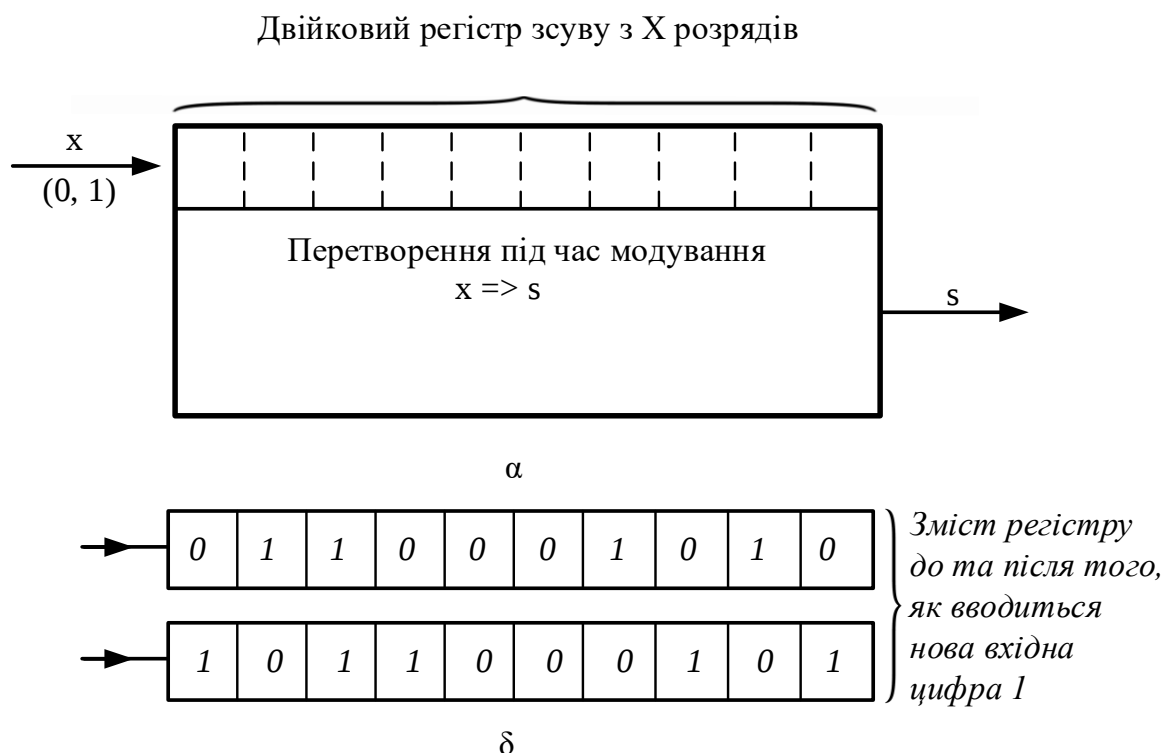
Рис. 1.6. Символи вхідного повідомлення, що зберігаються в пам'яті, скидаються після виходу з правого розряду K -розрядного двійкового регістра зсуву
