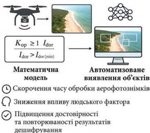
Рис. 3.4. Блок-схема математичної моделі дешифрування аерофотознімків морських акваторій та прибережних зон
